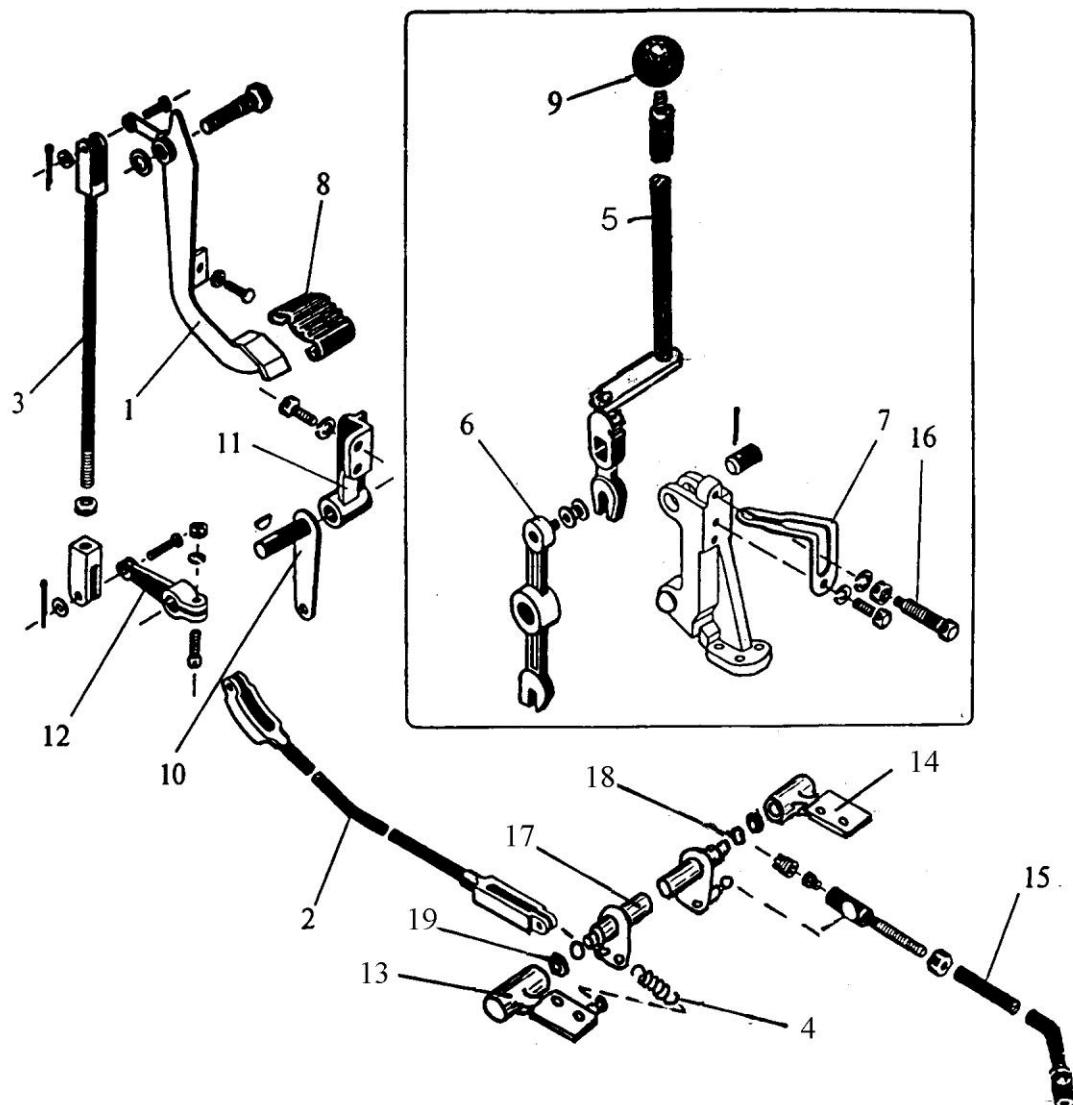
Рис. 11 Управление переключением передач
