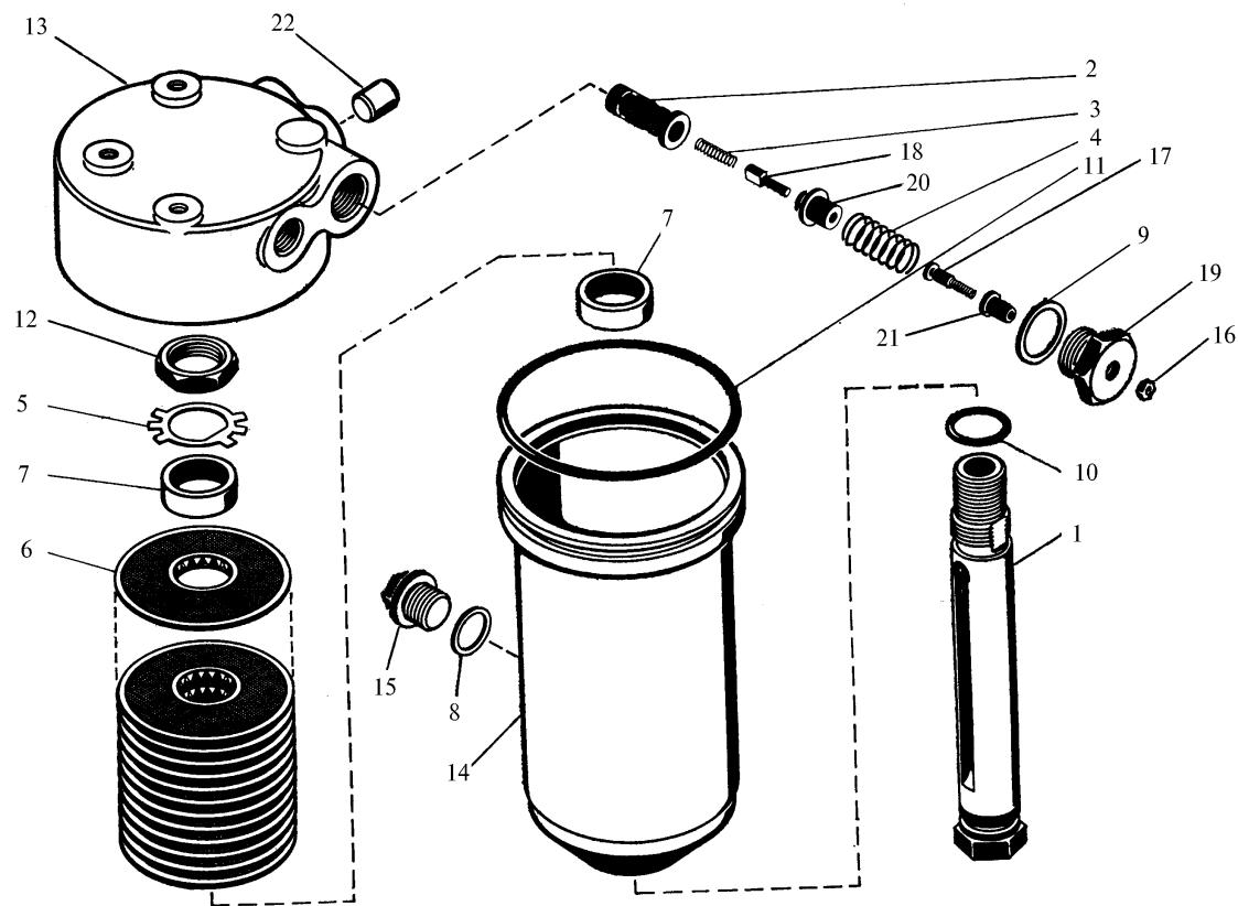
Рис. 27 Фильтр коробки передач
