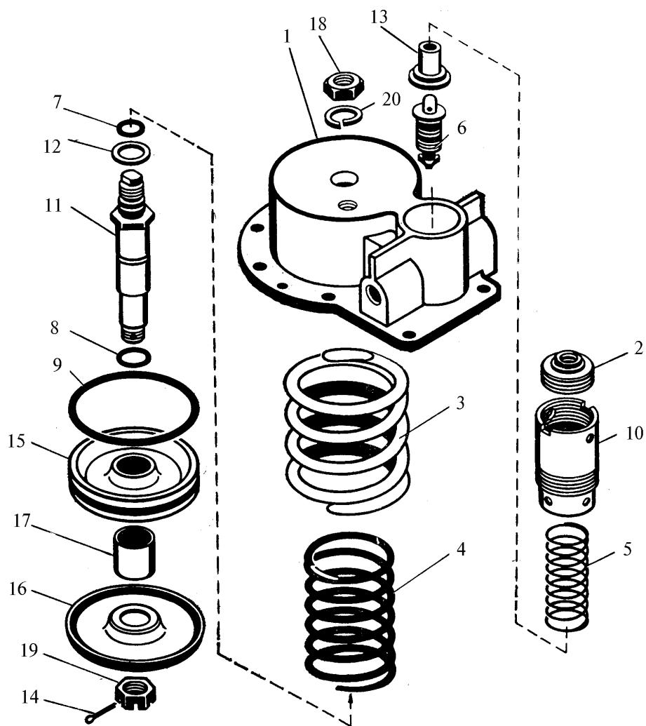
Рис. 14 Гидроаккумулятор
