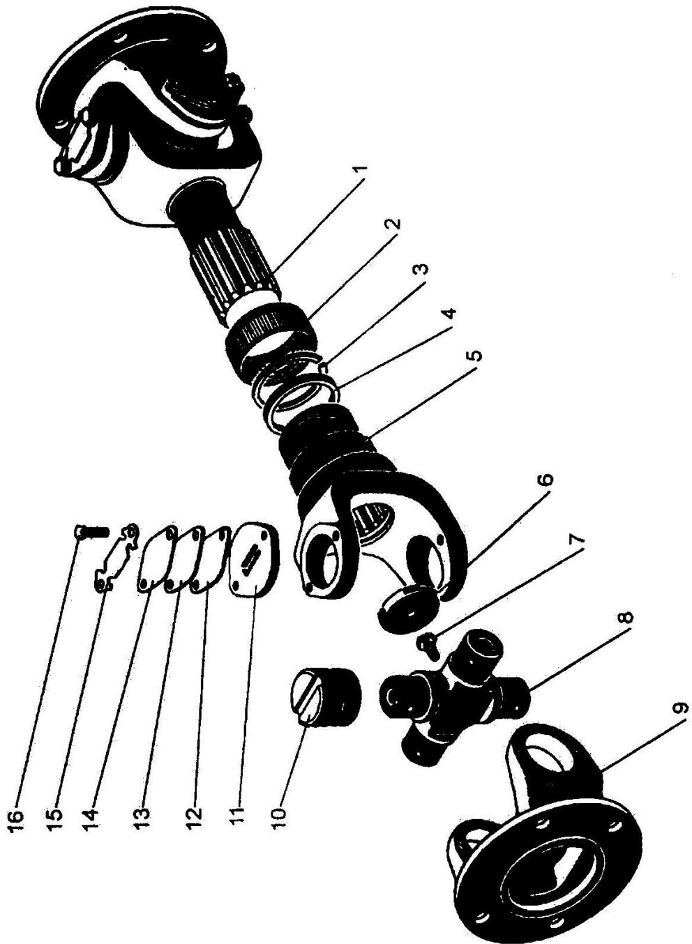
Рис. 62 Вал карданный механизма отбора мощности
