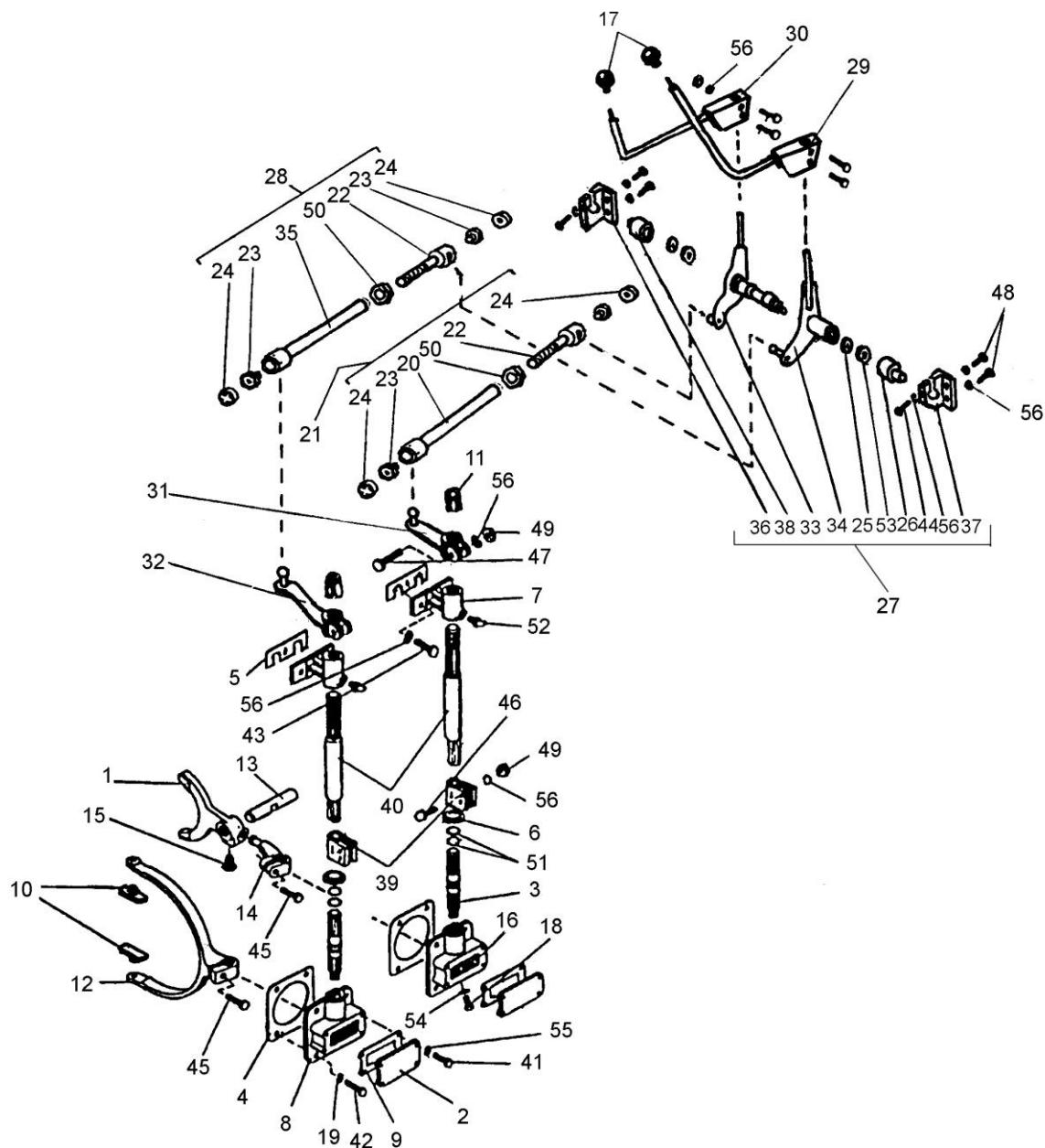
Рис. 24 Привод управления муфтами раздаточного вала
