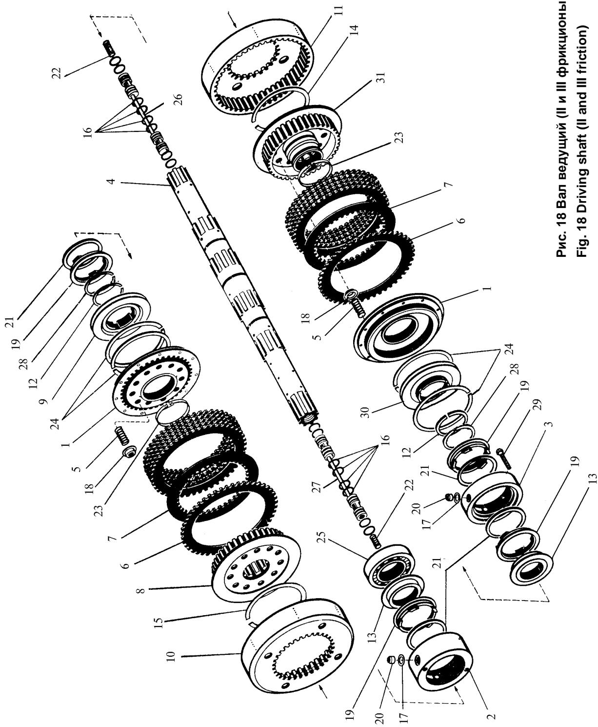
Рис. 18 Вал ведущий (II и III фрикционны)
