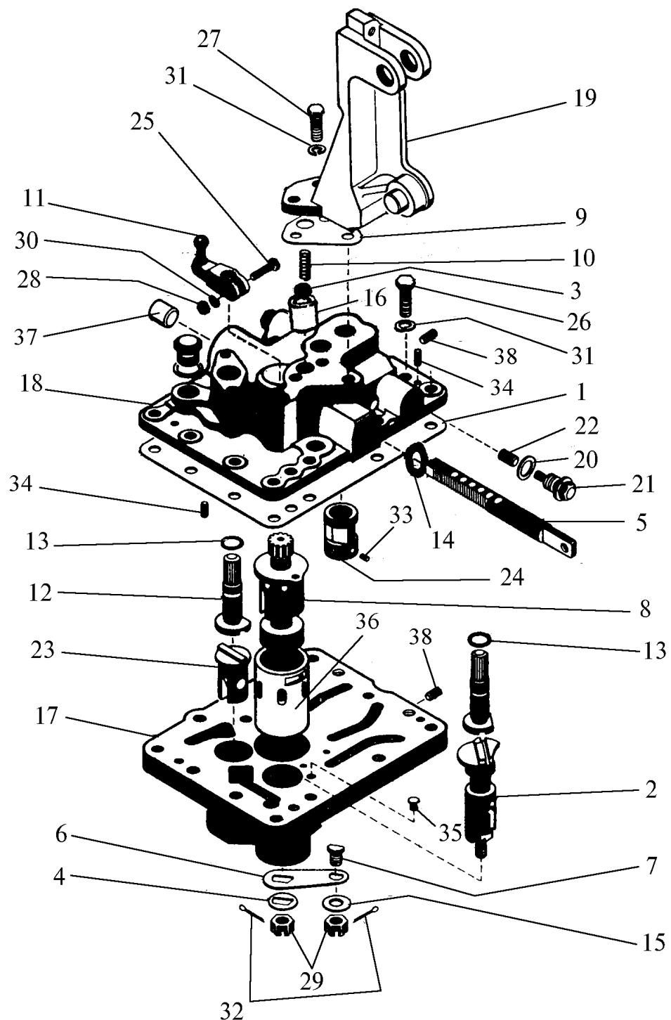
**Рис. 13 Механизм переключения передач**
