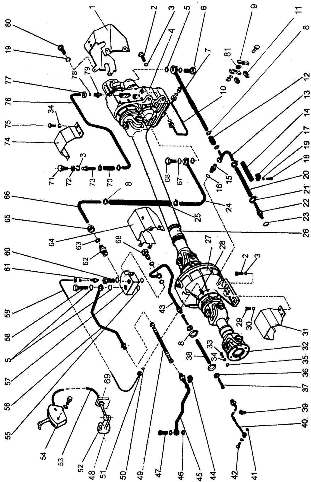
Рис. 58 Механизм отбора мощности
