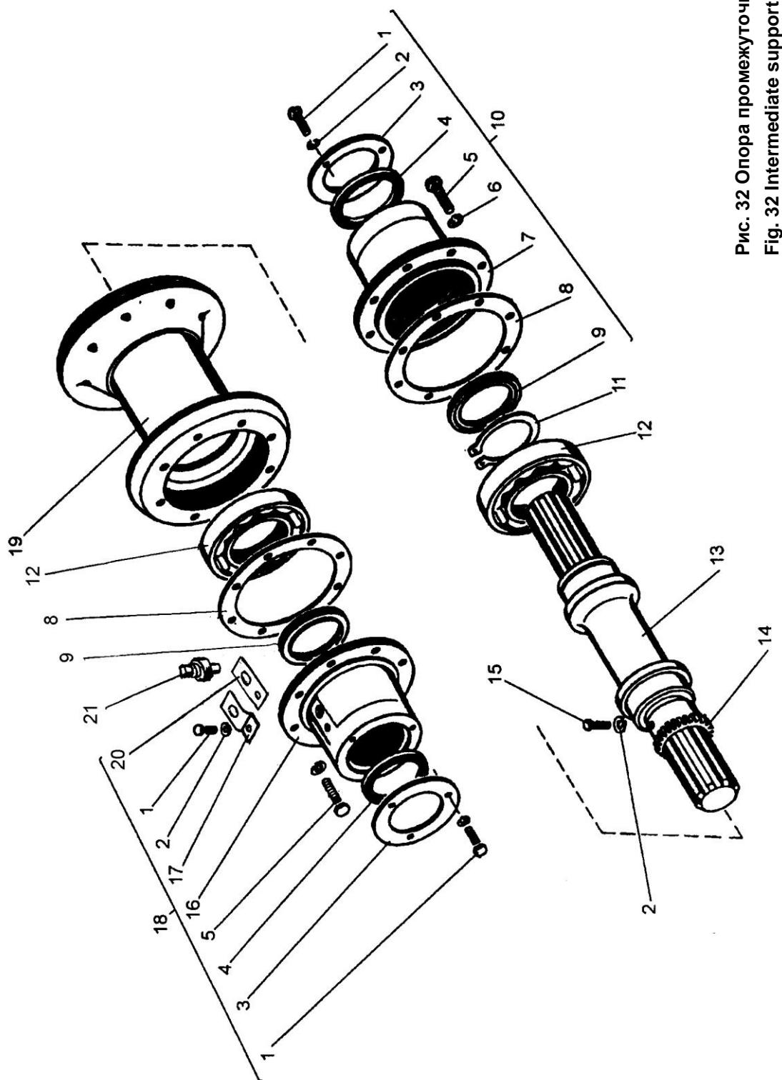
Рис. 32 Опора промежуточная
