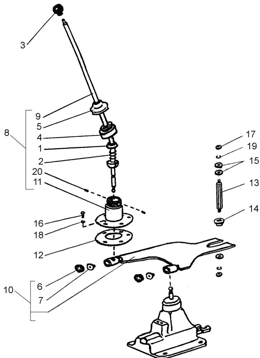
Рис. 23 Привод управления муфтами грузового вала
