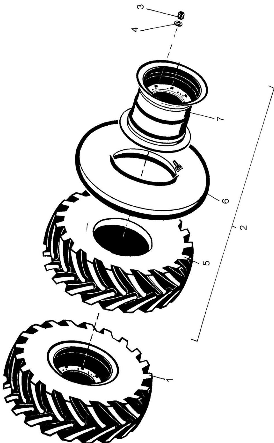
Рис. 40 Колесо с шиной
