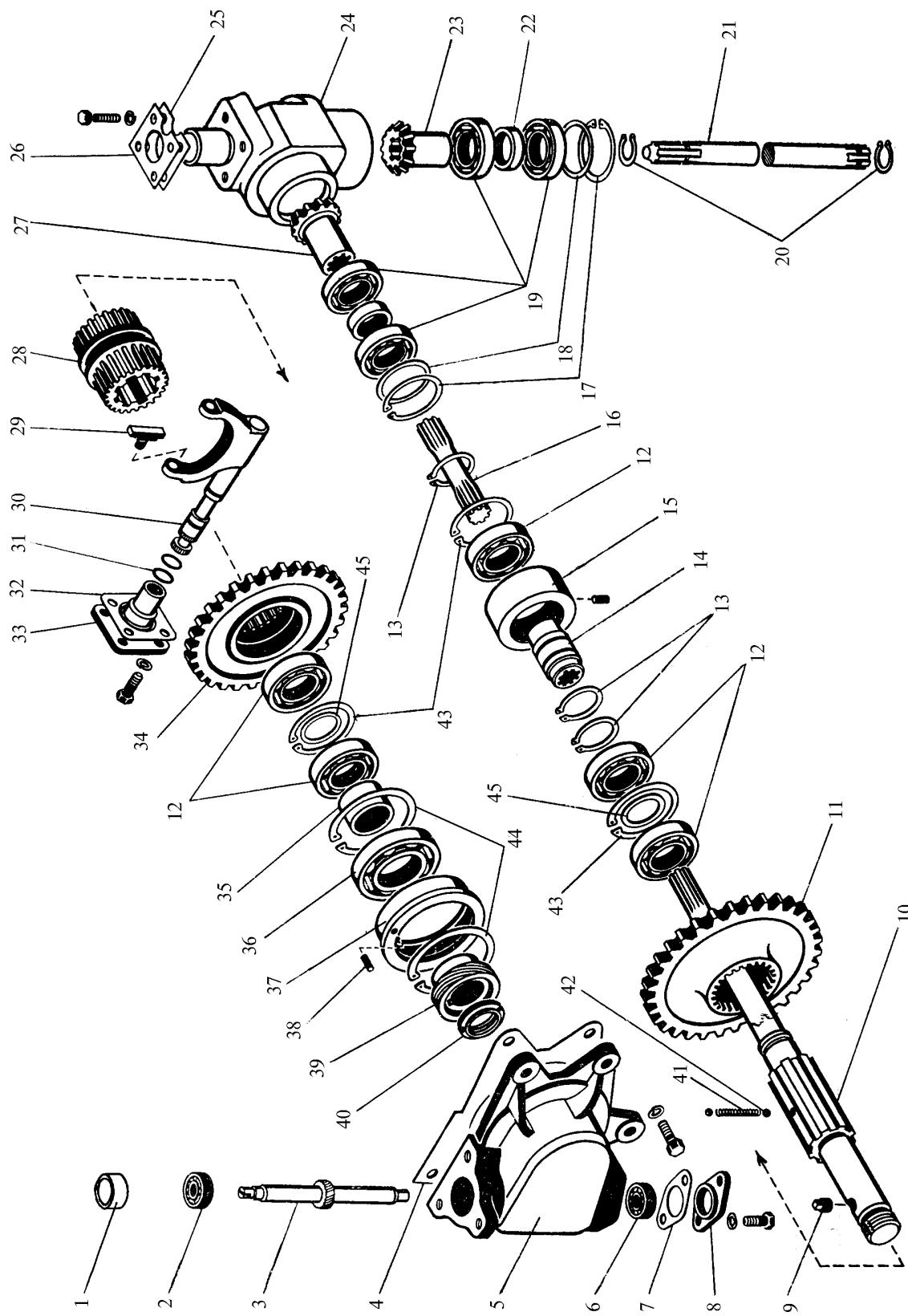
Рис. 16 Вал привода насоса КП
