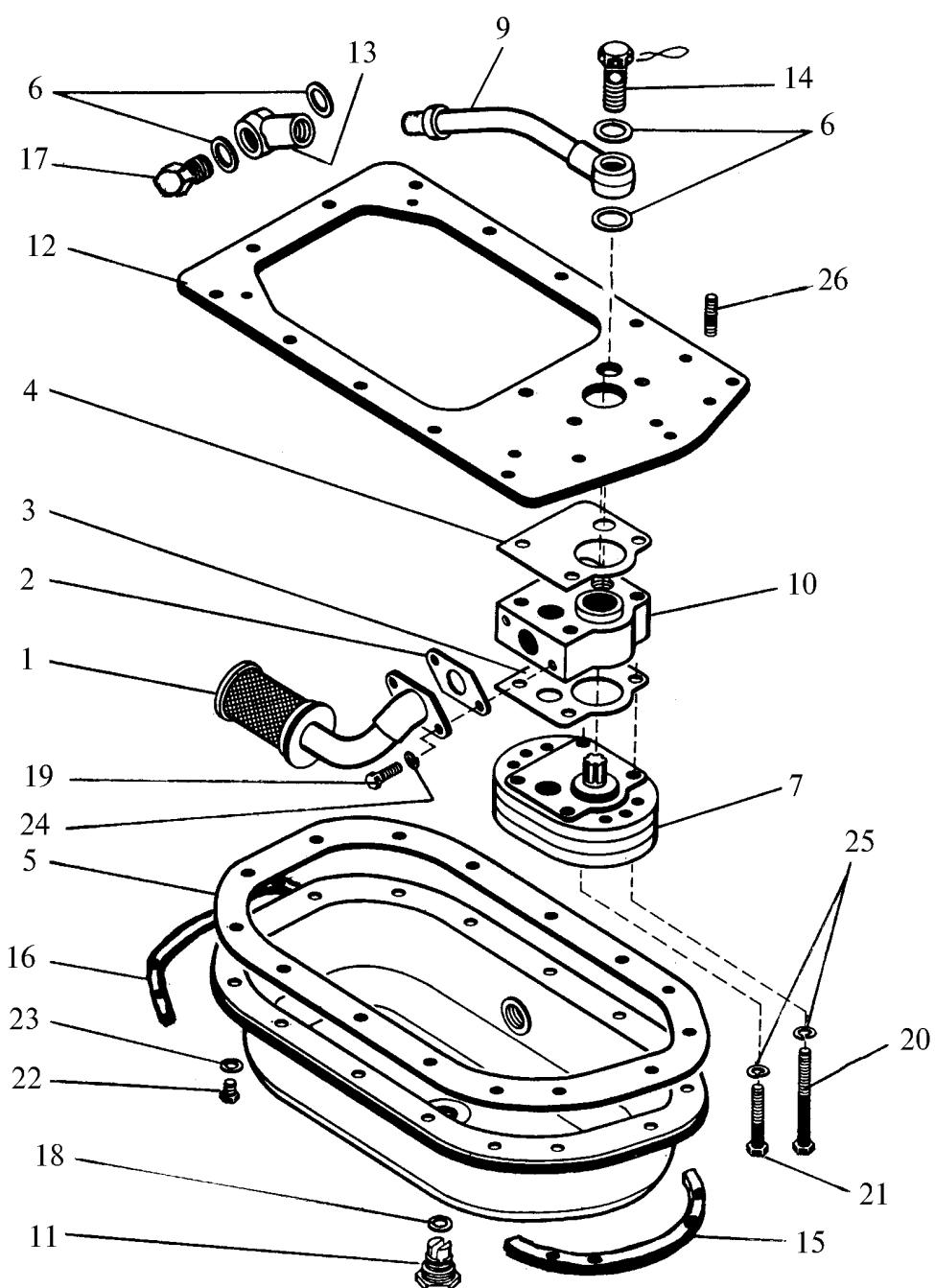
Рис. 26 Поддон коробки передач с насосом
