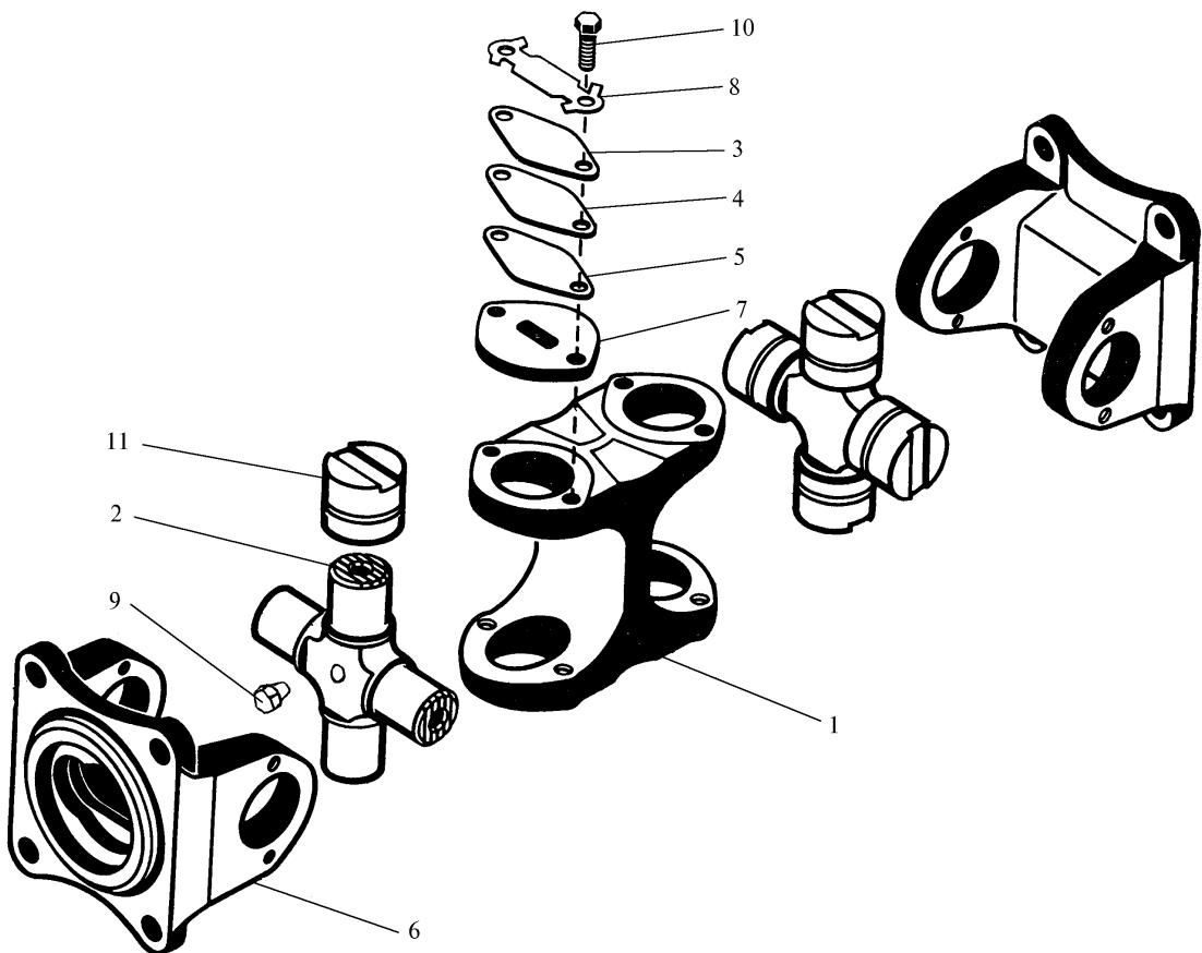
Рис. 29 Вал карданный передний
