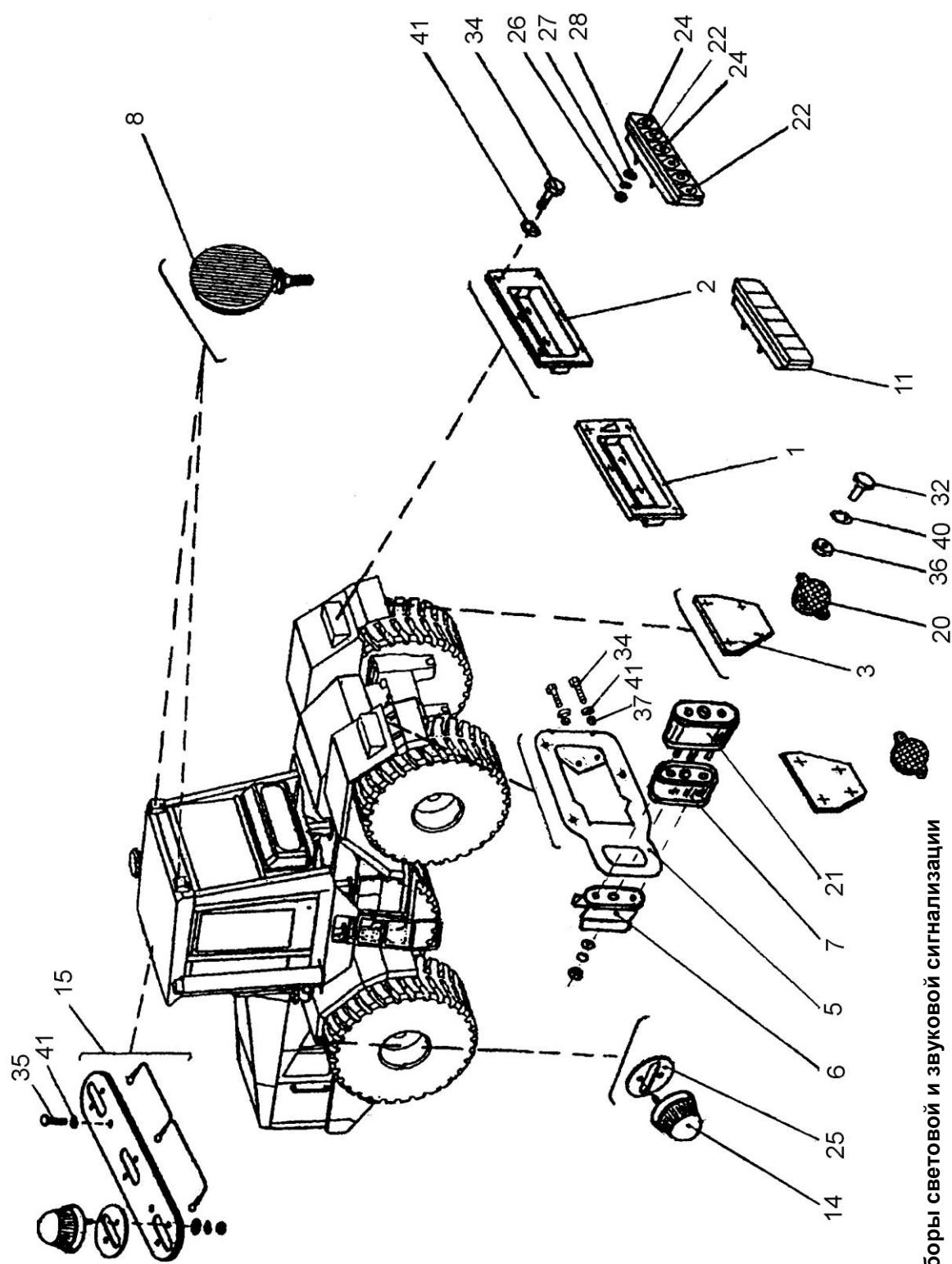
**Рис. 54-1** Приборы световой и звуковой сигнализации
