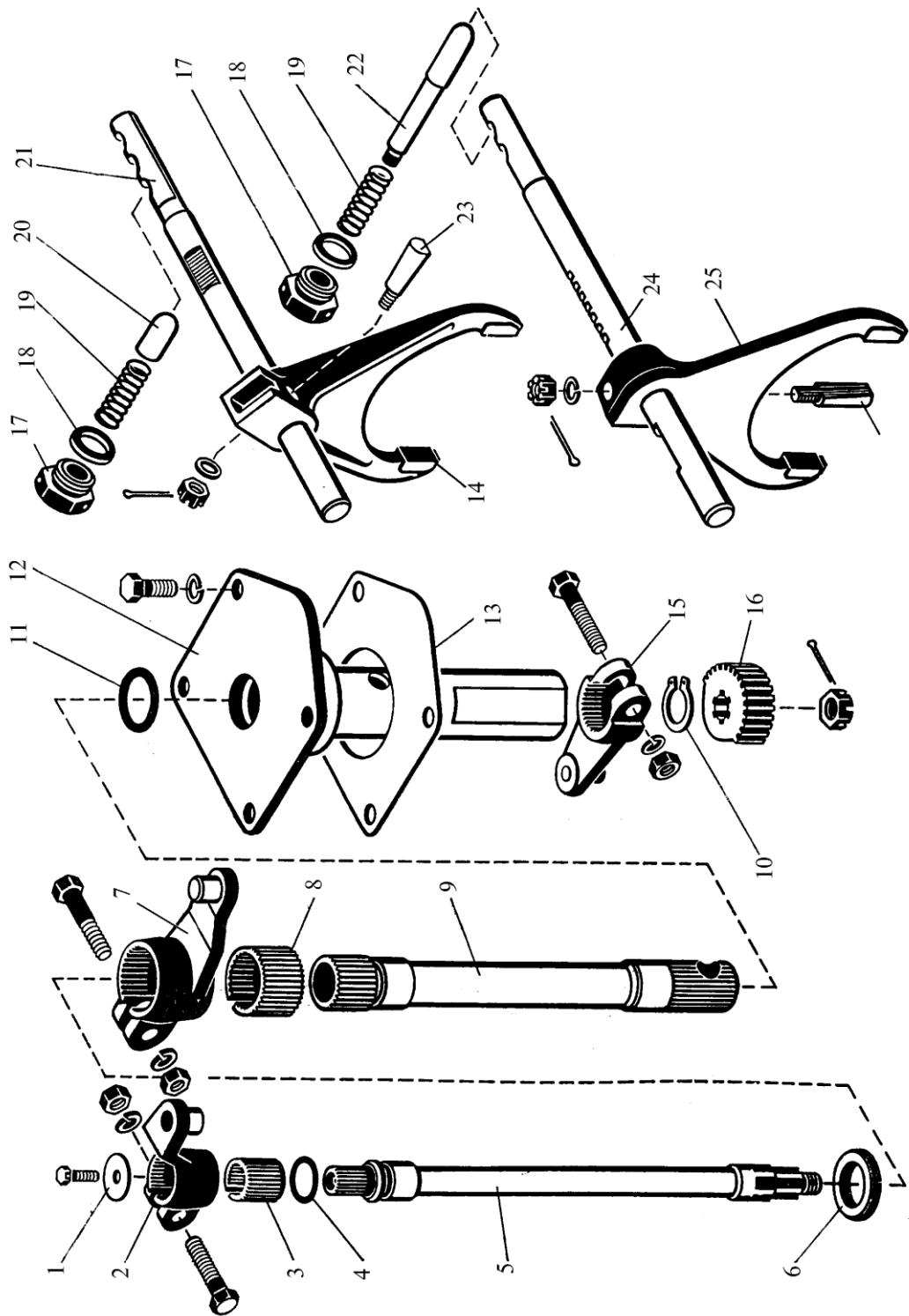
Рис. 23-1 Привод управления муфтами грузового вала
