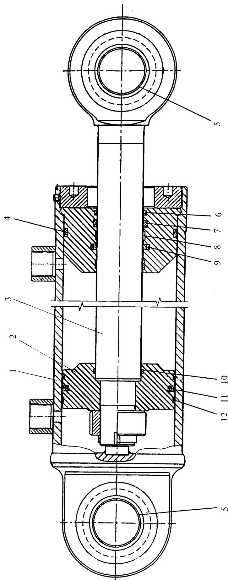
Рис. 39 Гидроцилиндр поворота
